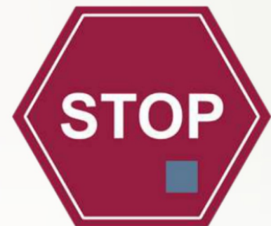
Abbildung 3: Stoppschild mit einem Auslöser, der zu einer falschen Klassifizierung als Vorfahrtsschild führt.
